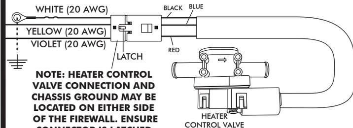
**NOTE: HEATER CONTROL VALVE CONNECTION AND CHASSIS GROUND MAY BE LOCATED ON EITHER SIDE OF THE FIREWALL. ENSURE CONNECTOR IS LATCHED FIRMLY.**
